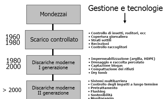
Figura 6.36 Evoluzione tecnologica delle discariche per lo smaltimento dei rifiuti
